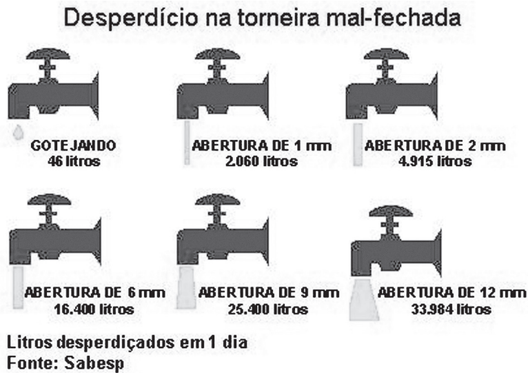
Figura 12: Desperdício de água por dia em torneiras com vazamento Fonte: Sabesp (2007)
